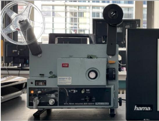
4. Auf den linken Spularm die Leerspule und auf den rechten Spularm die Testspule einlegen. Die Spulen mit den schwarzen Stoppfern fixieren.
